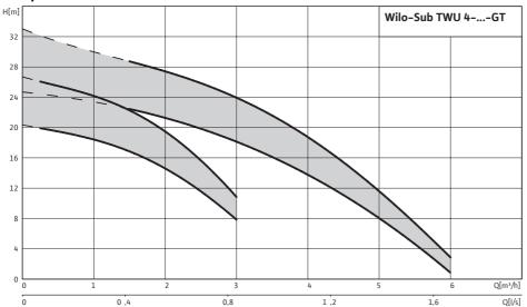
$3\sim400\ V$ ,  $50\ Hz$ ,  $p=1\ kg/dm3$ ,  $v=1x10-6\ m2/s$ , ISO 9906 Annex A
