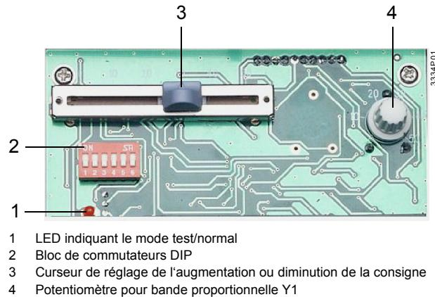
1 LED indiquant le mode test/normal
