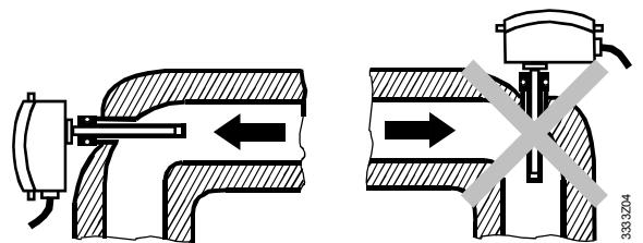
El controlador debe montarse en un codo de la tubería con la vaina de protección enfrentándose a la dirección del flujo.
