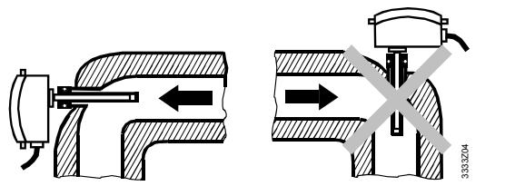
Il regolatore dovrebbe essere montato in una curvatura con il bulbo rivolto controcorrente.
