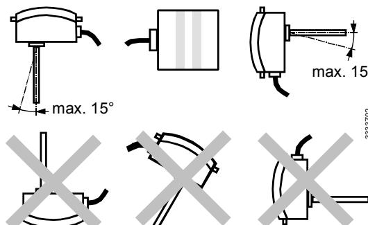
Le régulateur ne doit pas être retourné ; l'entrée de câble de doit pas se trouver en haut.
