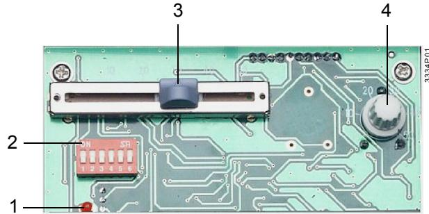
1 LED-lampa för testdrift/normaldrift
