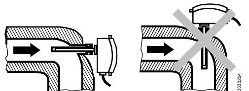
Nach Möglichkeit in einen Rohrbogen einbauen. Der Tauchstab soll gegen die Strömung zeigen.
