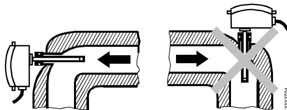
Regulatorn skall om möjligt monteras i en rörböj. Dykröret skall peka mot strömmen.
