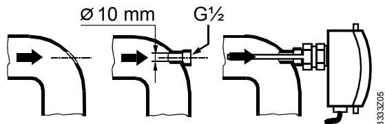
4. Montera dykröret i den gängade nippeln. Om så erfordras använd tätningsmaterial (hampa, teflonband osv.)
