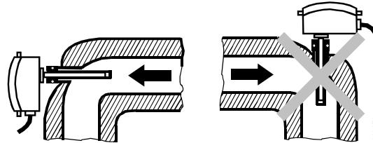
Monter l'appareil si possible dans un tube coudé. Le plongeur doit être dirigé contre le sens d'écoulement.
