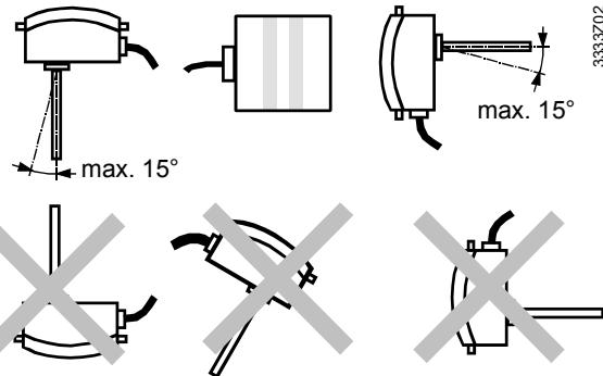
El controlador no debe montarse boca abajo y el cable no debe introducirse desde arriba.
