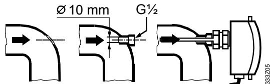
4. Fissare la guaina di protezione e, se necessario, utilizzare materiali per guarnizioni (canapa, teflon o similari).
