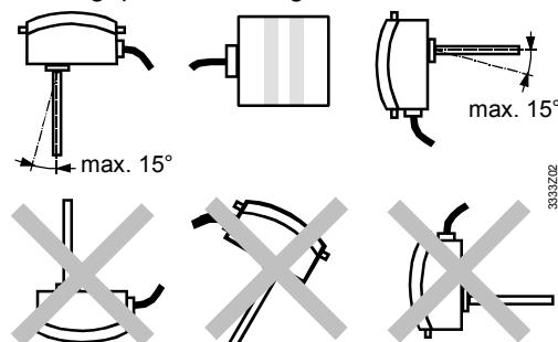
De regelaar mag niet op zijn kop staan; de kabelingang mag niet naar boven zijn gericht.
