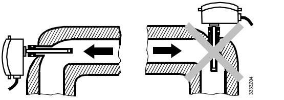
Regulator należy montować w kolanie rurociągu, a trzpień czujnika powinien być skierowany „pod prąd” względem kierunku przepływu
