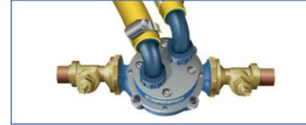
Die Gleitbuchse muss gereinigt und, soweit erforderlich, mit Silikonöl oder Silikonfett geschmiert werden. Prüfen Sie vor der Verwendung, ob die Buchse hinein- und herauspringt. O-Ringe könnten sich abnutzen oder verloren gehen und müssen deshalb evtl. hin und wieder erneuert werden. Eine Packung mit Ersatz-O-Ringen ist erhältlich.
