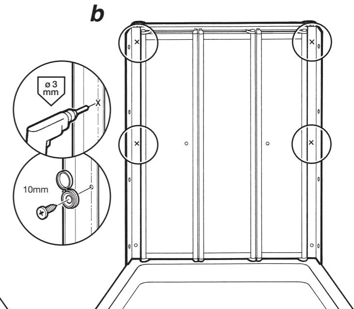
**NL** Controleer of de deur goed in het midden zit en volkomen verticaal is. Boor aan de binnenkant van de muurprofielen op de twee plaatsen zoals getoond wordt, met gebruikmaking van het 3mm boortje. Maak vast met 10mm schroeven (a). Controleer of de deur verticaal is, boor de volgende 4 gaatjes en maak vast met gebruikmaking van 10mm schroeven (b).
